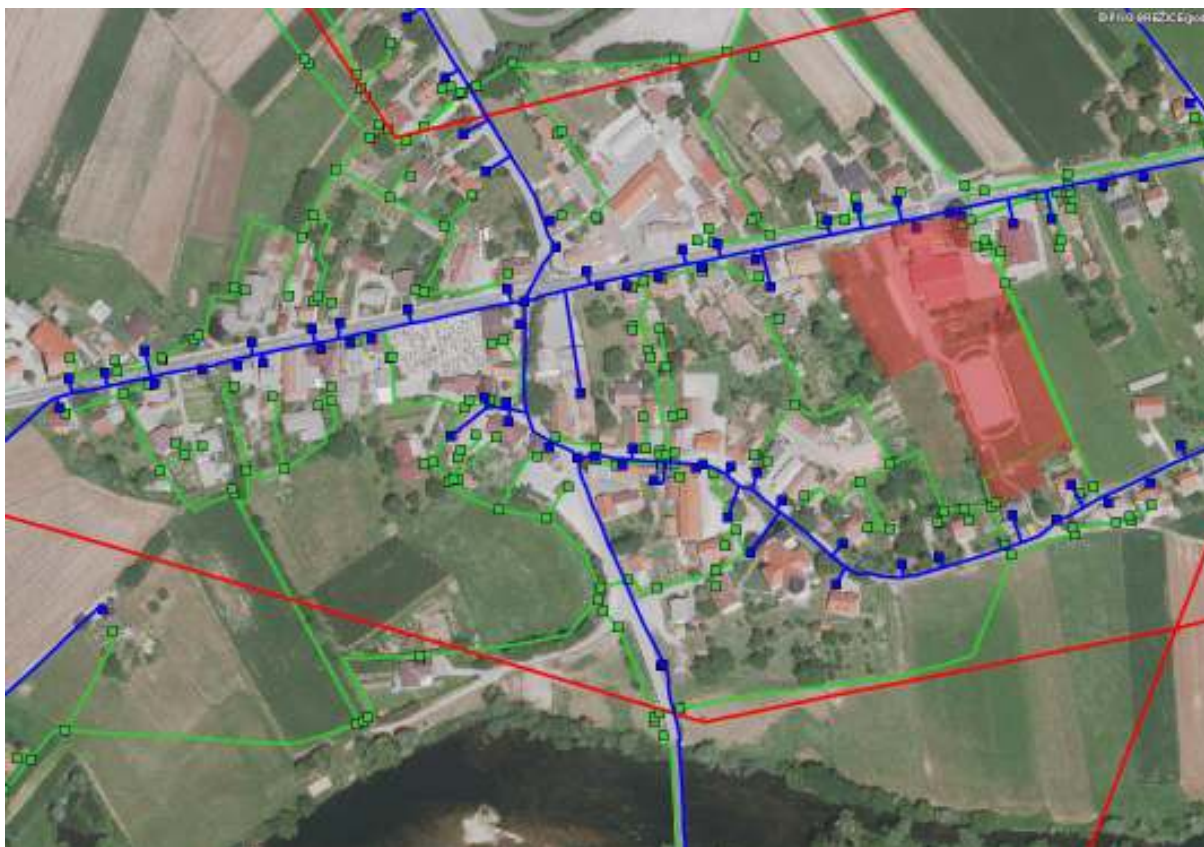
Slika 19_Omrežje gospodarske javne infrastrukture – elektrika, vodovod Legenda: zeleno _telekomunikacije; rdeče _elektrovod; modro _vodovod
